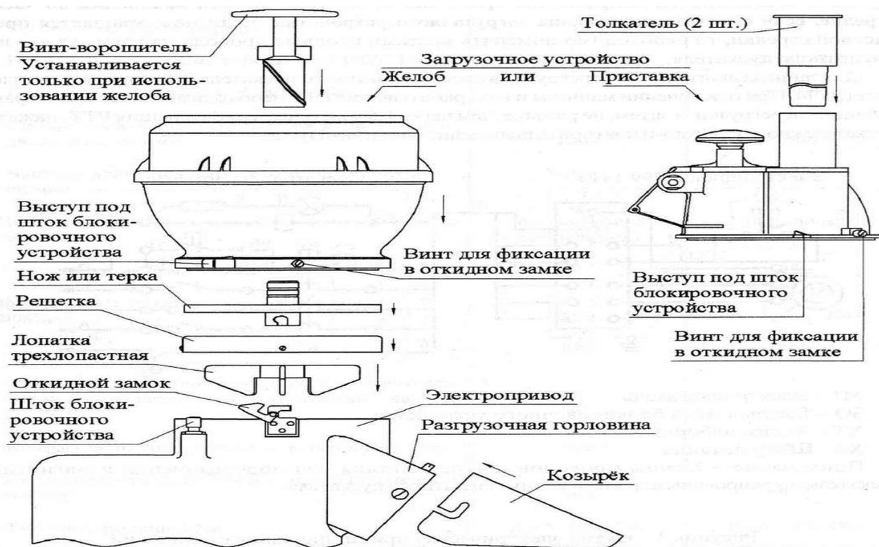
**Запрещается мыть машину водяной струей! Это является нарушением правил эксплуатации и приводит к коррозии подшипников несущего вала и последующей поломке механизма машины.**
